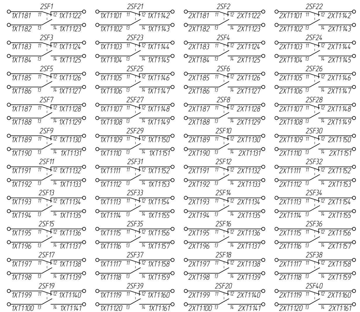
РЕЗЕРВ (Блок-контакты положения автоматических выключателей)
